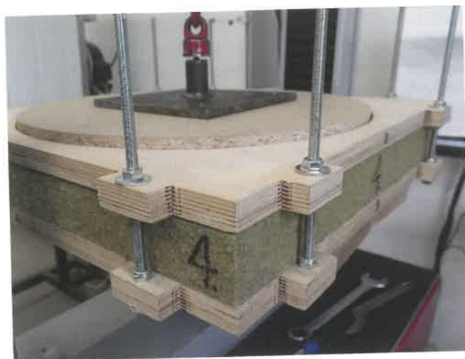
Obr. 4: Vzorek pro zkoušku protažením hmoždinky izolantem podle EN 16382.
