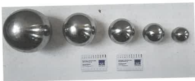
Obr. 3: Sada ocelových koulí pro zkoušku rázem dle EN 13497 o váze 0,51 kg až 7,91 kg
