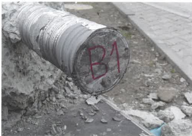
Obr. 4: Příčný řez kabelovým kanálkem po injektáži
