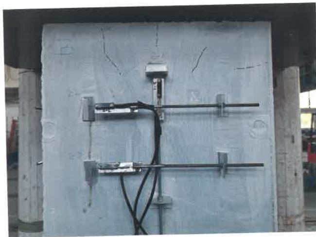
Obr. 3: Měření příčných a podélných deformací zkušebního bloku
