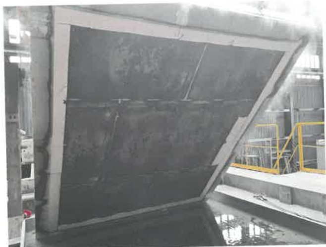
Obr. 4: Vložení vzorku do kádě s vodou po požární zkoušce
