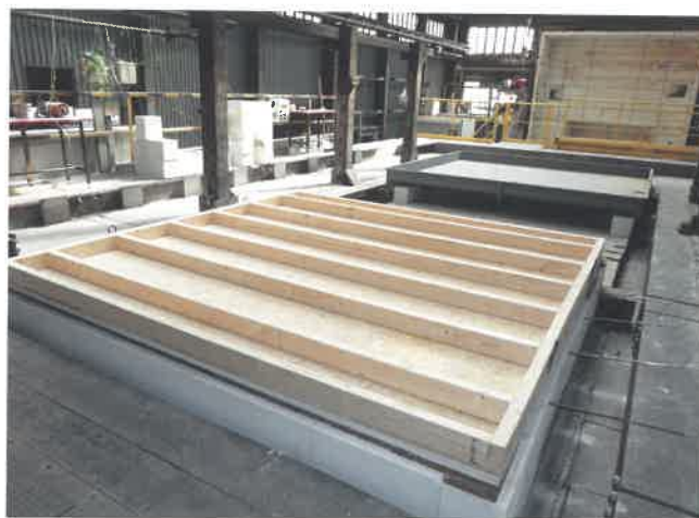
Obr. 2: Pohled na zkušební vzorek (NS) před požární zkouškou
