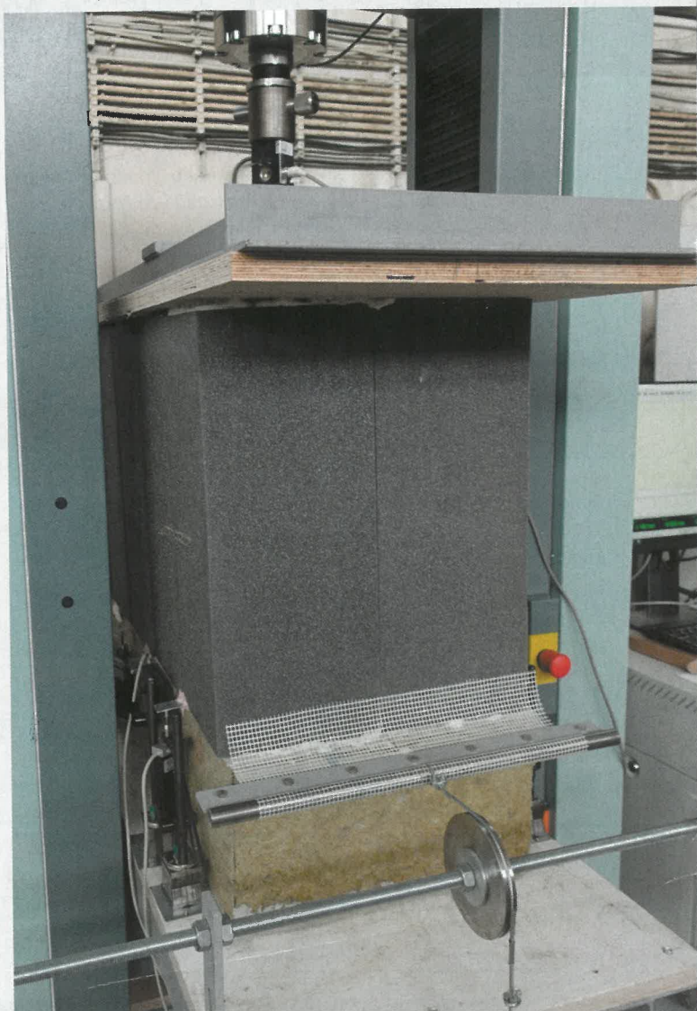
▼ Obr. 2 Uspořádání zkoušky ETICS podle ČSN EN 13495, metody B
