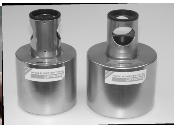
Obr. 4 Kovadlina původní / EURO
